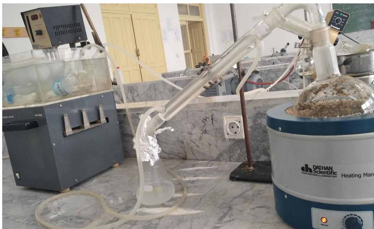
**Figure 03** : Dispositif d'hydrodistillation (Photo originale).
