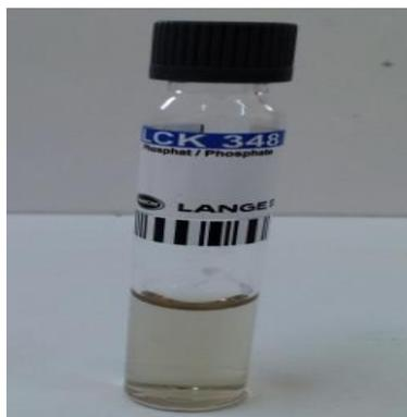
**Annexe 8** : Solution standard LCK348 à 1.5-15mg/l PO<sub>4</sub>
