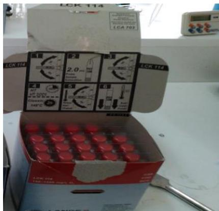
**Annexe 4 :** Solution standard de  $K_2 Cr_3 O_7$  LCK 114 150-1000mg/l  $O_2$
