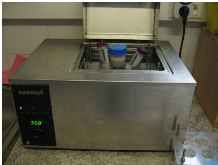
Figure 16 : cuve pour bain-marie contenant le milieu de dilution et les récipients allant accueillir le sperme, à température corporelle (36.8°C)
