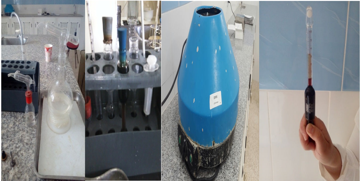
Photo N° 15:butyromètre - les produits utilisés- centrifugeuse-séparation des couches.(GT).
