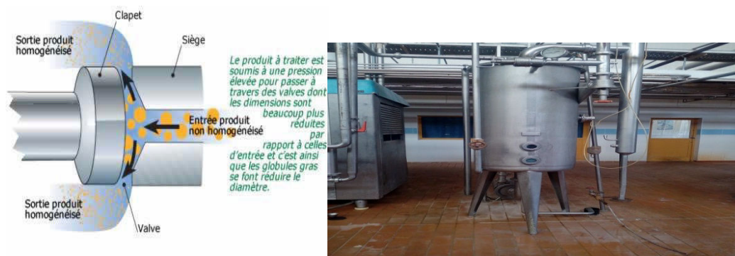
Figure N° 04: Principe de fonctionnement Photo N°02 : Homogénéisateur (GT). D'un homogénéisateur.
