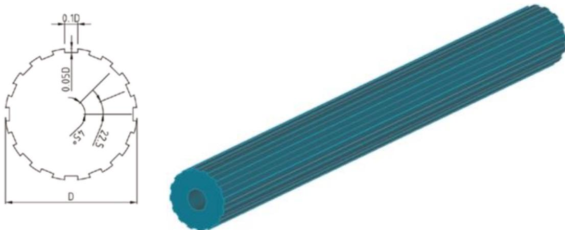
Figure I.12 : Forme des rainures et emplacement des trous de pression (Unité : mm).
