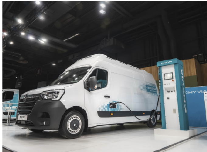
Figure I.13 – La recharge en hydrogène s’effectue grâce à des pompes capables d’injecter très rapidement l’hydrogène .[16]
