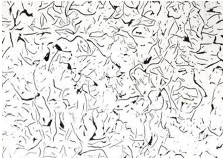
Figure I.4 : Microstructure d'une fonte grise à graphite lamellaire [13].
