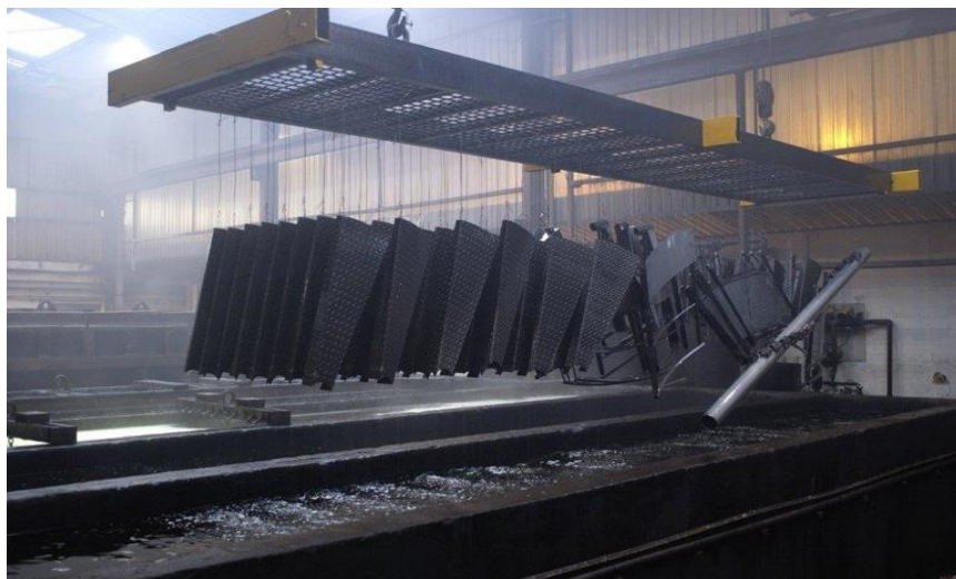
Figure II.2. Immersion en bain fondu métaux fondus [39]
