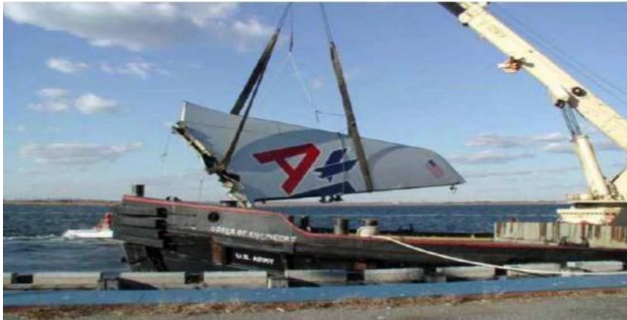
Figure I.2 : Stabilisateur vertical, qui s'est séparée du vol American Airlines 587, conduisant à un accident mortel [04].
