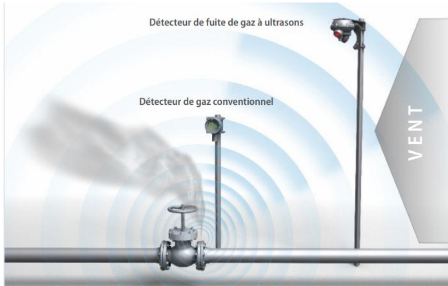
La figure.2.3 : Couverture de détection des fuites de gaz affectées par le vent [21]
