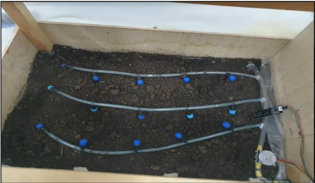
Figure III.18 : Conduite principale et rampes latéraux
