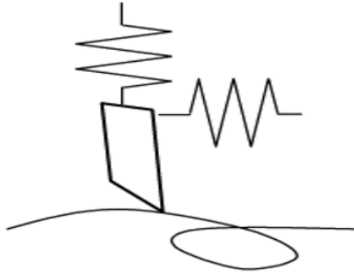
Figure I.6 – Apparition du broutement par couplage de modes [6].
