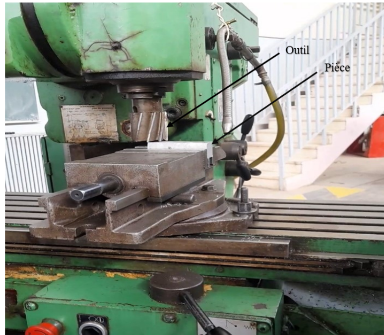
Figure I.1 – Usinage par outil coupant .
