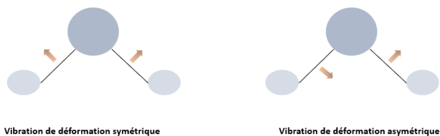
Figure II.6 : Vibration de déformation symétrique et asymétrique.
