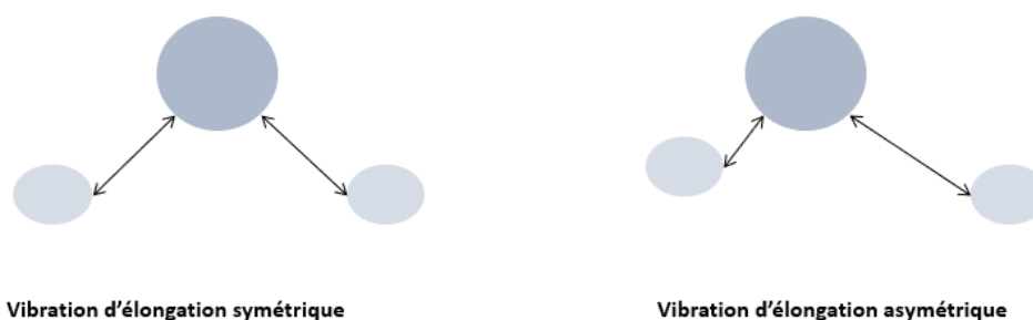
Figure II.5: Vibration d'élongation symétrique et asymétrique.
