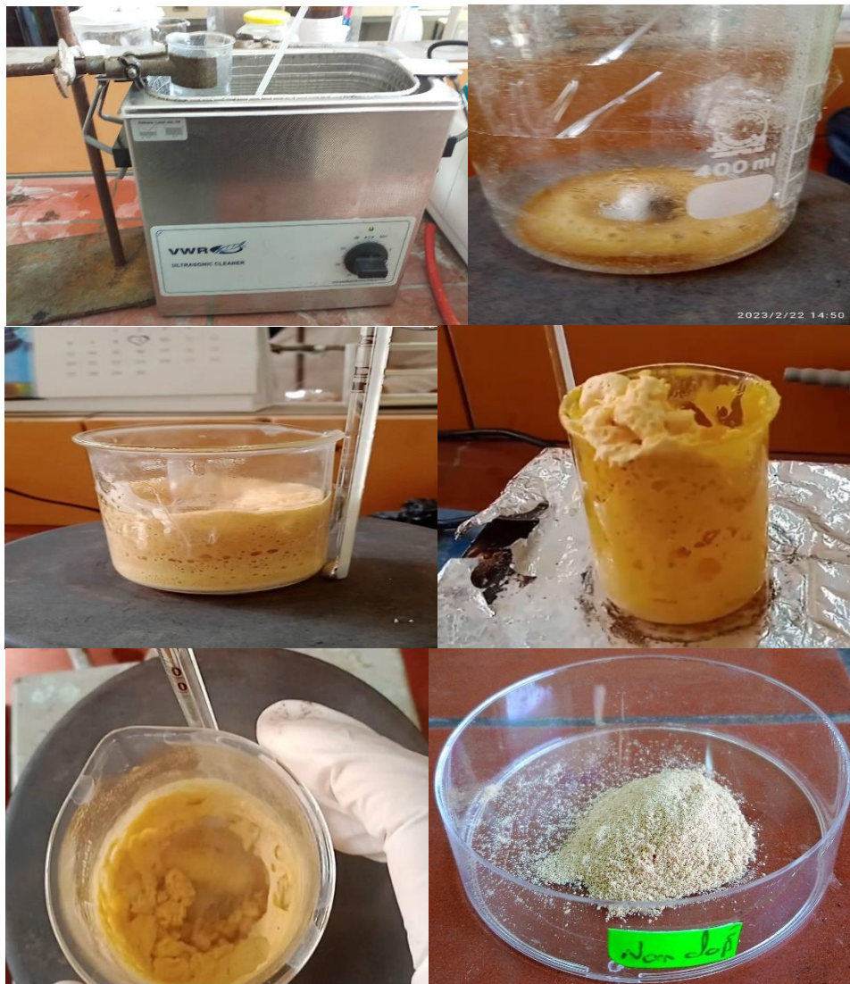
Figure III.1: Préparation de \text{SrMn}_2\text{O}_4 par sol gel.
