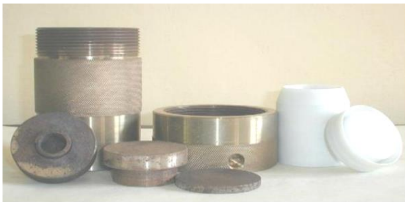
Figure I.10 : Autoclave populaire utilisé pour le traitement hydrothermique [38].
