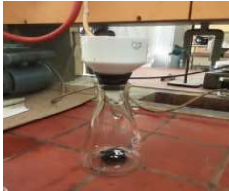
Figure.III.36: Filtration sous vide d'huile usagée de moteur.
