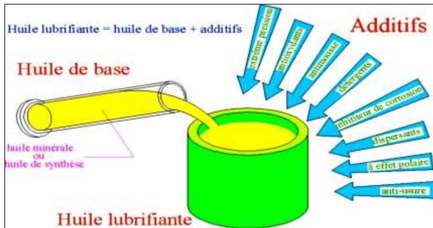
Figure.II.11: Principe de composition d'une huile [68].
