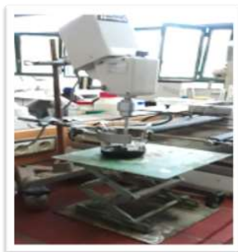
Figure.III.37: Agitation mécanique d'huile avec argile.
