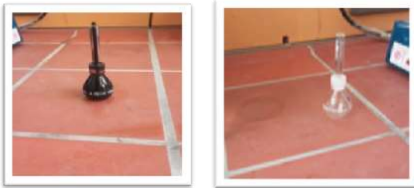
Figure.III.33: Pycnomètre vide et le pycnomètre remplie par l'huile de moteur usagée.
