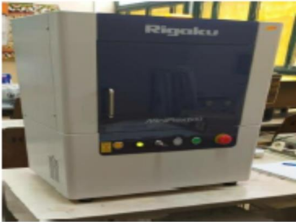
Figure II.03 : Diffractomètre RX utilisé.
