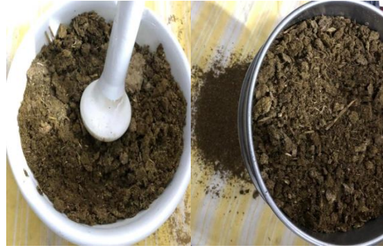
Figure N° 09: Compost tamisé (0,5 et 2mm)
