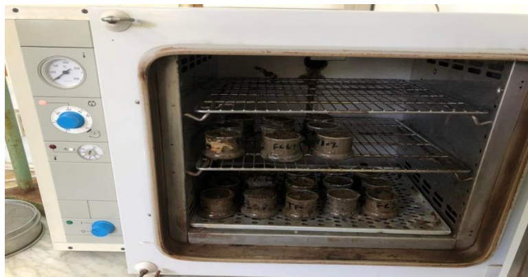
Figure N° 12 : Séchage Les échantillons dans l'étuve à 105°C.
