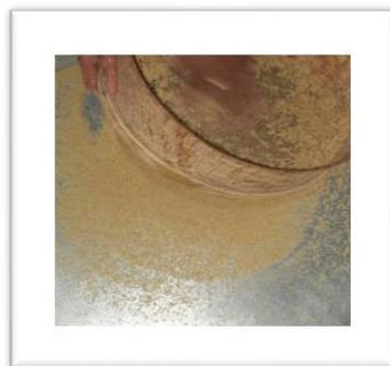
**Figure 11 :** Emottage et calibrage de couscous précuit.
