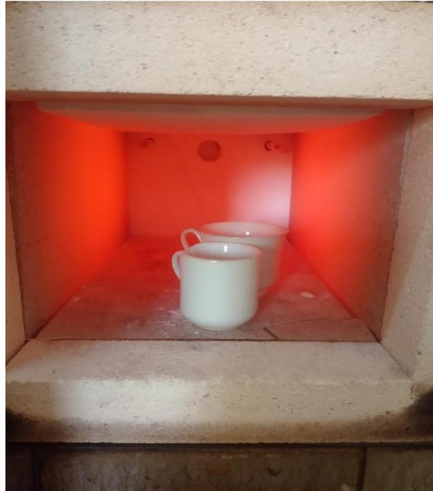
*Figures 4: mise des échantillons dans un four à 550°C*
