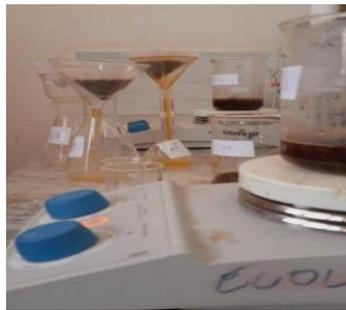
**Figure 23.** Agitation de la solution pendant 3h.
