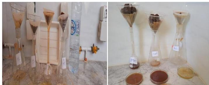
**Figure 24.** La filtration et le séchage à l'air libre.
