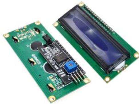
**Figuer III.14:** Écran LCD 1602 16×2 avec interface I2C/IIC – rétroéclairage bleu
