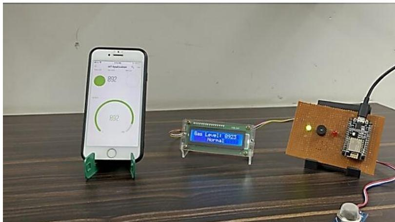
**Figure IV 10 :** connecte avec blynk
