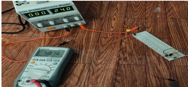
Figure IV. 4 : La réalisation d'un diviseur de tension.
