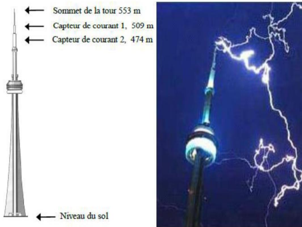
Figure I. 5: Exemple de mesure de courant de foudre en utilisant une tour instrumentée. Tour CN à Toronto au Canada [2][13].
