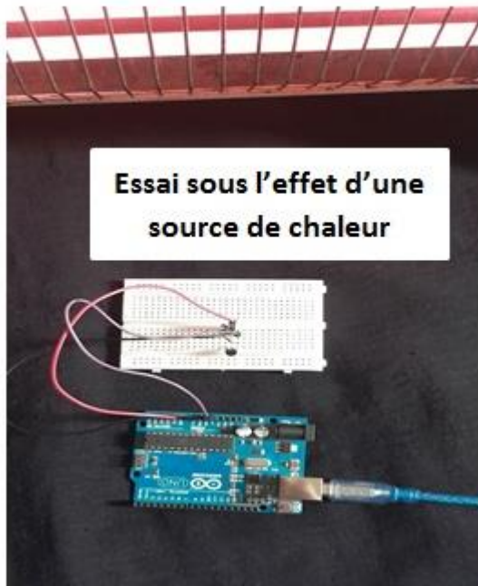
Figure 4.11. Présentation du montage à trois capteurs ainsi que les deux essais froid et chaud
