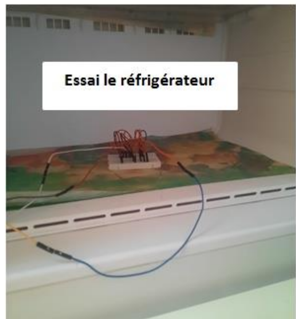
Figure 4.11. Présentation du montage à trois capteurs ainsi que les deux essais froid et chaud
