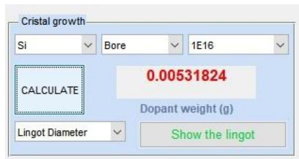
**Figure 3.6 :** Calcule de la masse en dopant.
