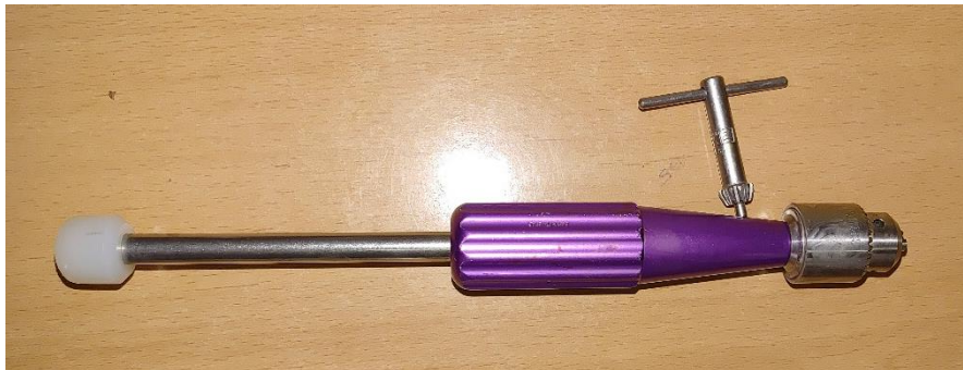
Figure VI-6. Le mandrin de Jacobs, utilisé pour la manipulation de la broche orthopédique
