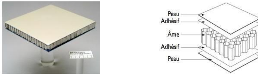
Figure 15:une structure en sandwich (image NASA) et ses constituants. Image (2) (GENDRE)
