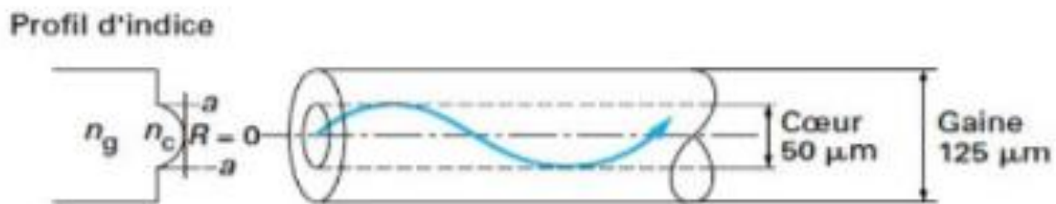
Figure I-5: Fibre multimode à gradient d'indice [5].
