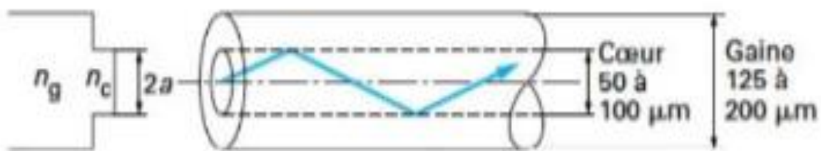
Figure I-4: Fibre multimode à saut d'indice [5].
