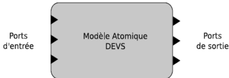
Figure II-3.Représentation graphique d'un modèle DEVS atomique
