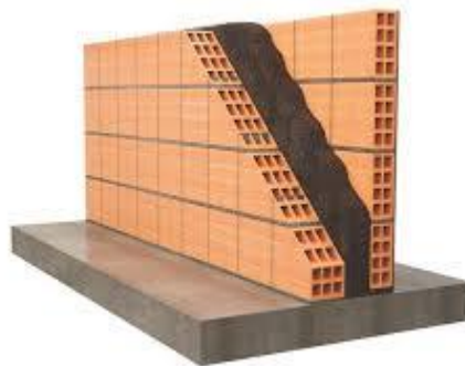
Figure I.06 : mur en double cloisons
