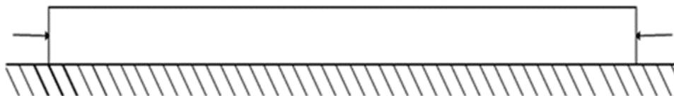
**Figure V-5:**Mise en tension de la dalle dans le sens longitudinal
