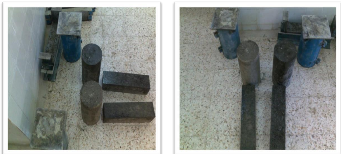
Figure (3.22) : Démoulage des éprouvettes cylindriques et prismatiques la conservation se fait à une température de 20 \text{ °C} \pm 2 \text{ °C} , dans l'eau.
