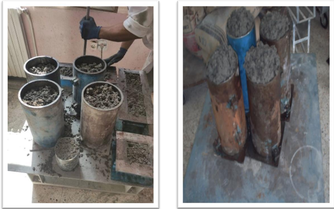
Figure (3.21) : Vibration de béton
