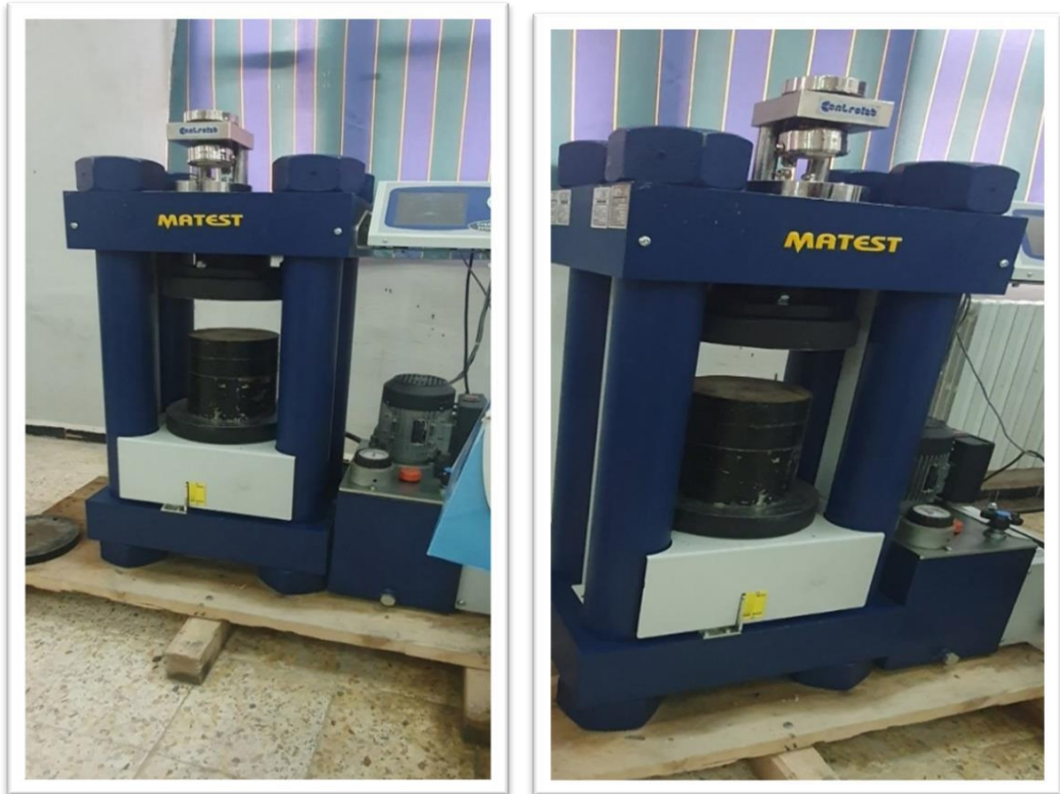
Figure (3.16) : La machine pour essai de compression et affichage de la résistance
