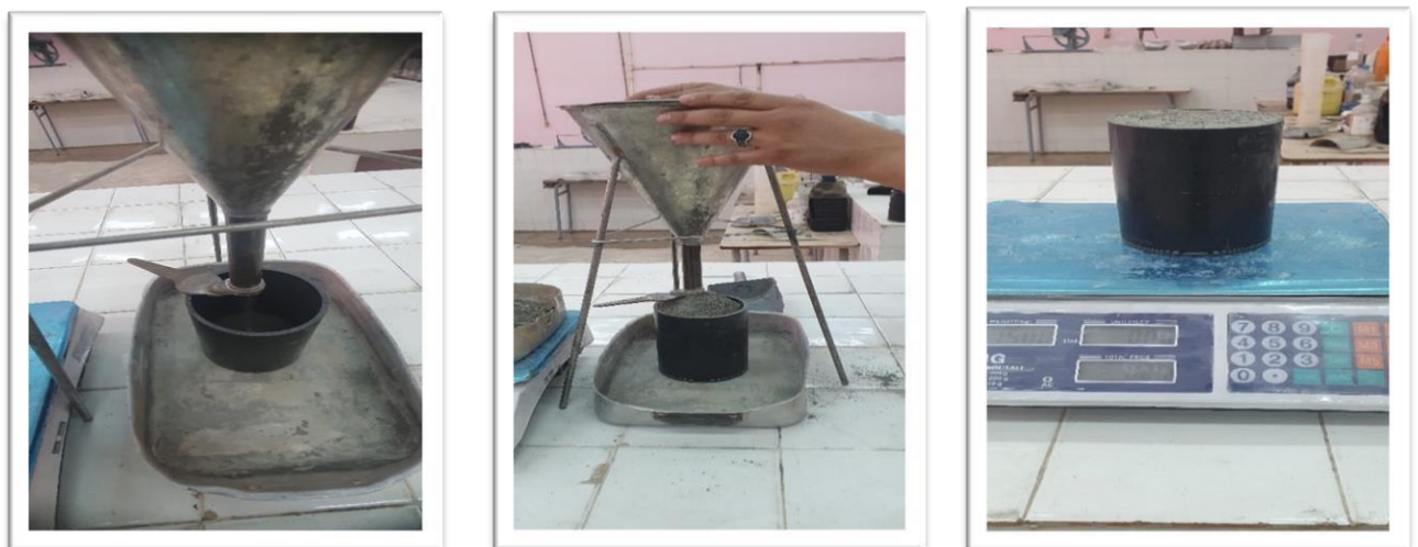
Figure (3.11) : Détermination de la masse volumique apparente de ciment
