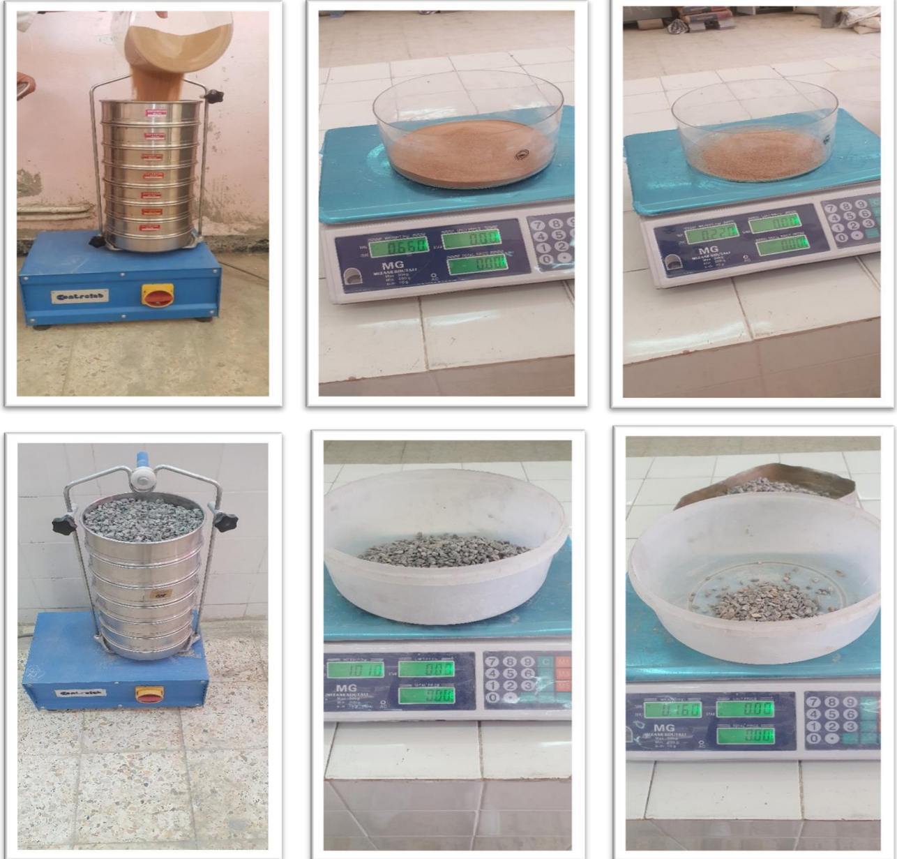
Fuguer (3.9) : Essai d'analyse granulométrique de sable et gravier (nature, recyclé)
