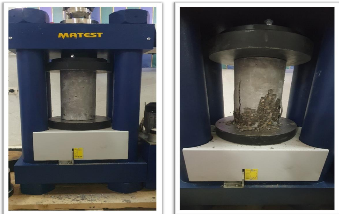
Figure (3.24) : Essais de compression éprouvettes cylindriques (16x32) cm 2 des bétons BHP et BHPR.
