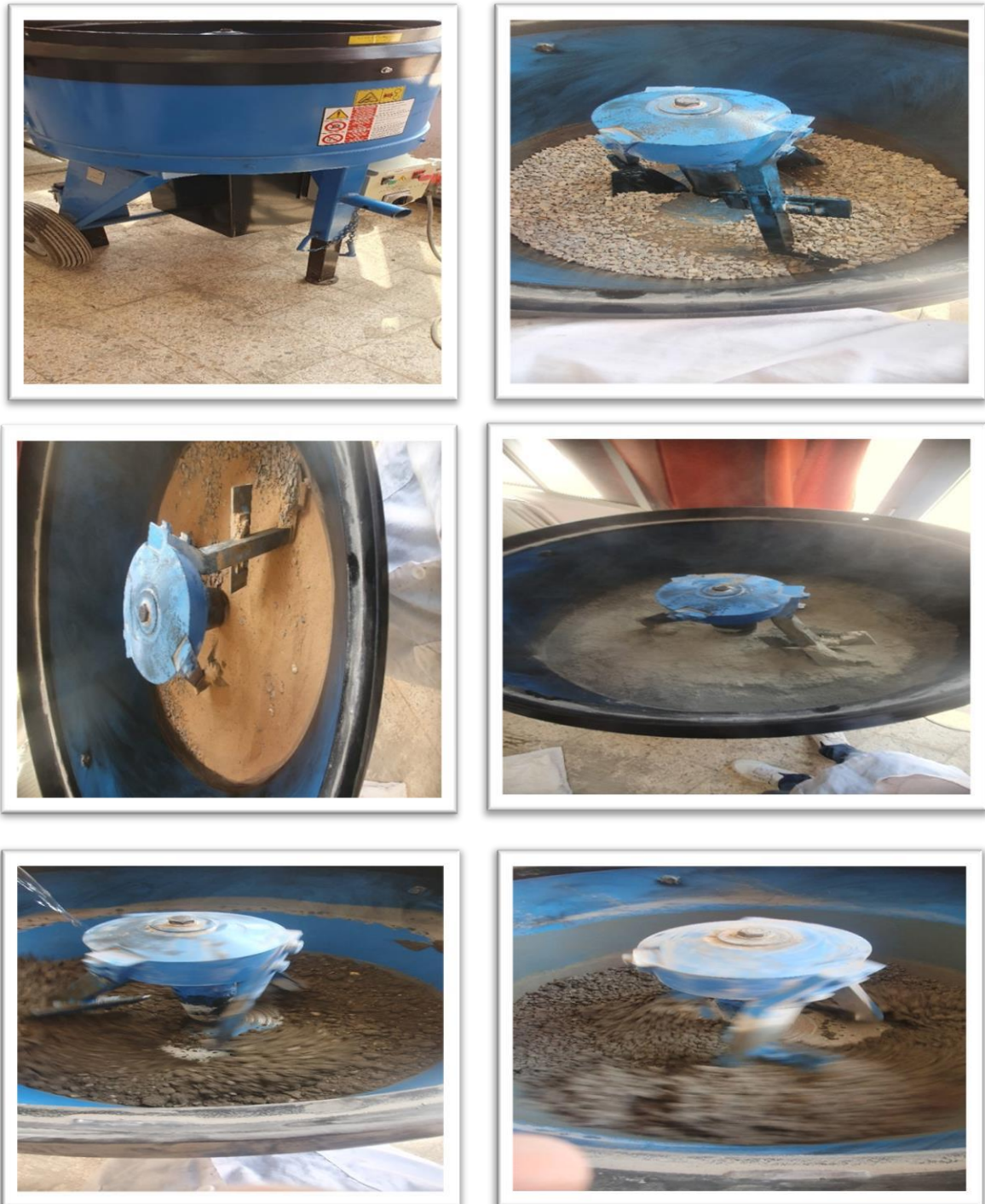
Figure (3.19) : Malaxage du béton
