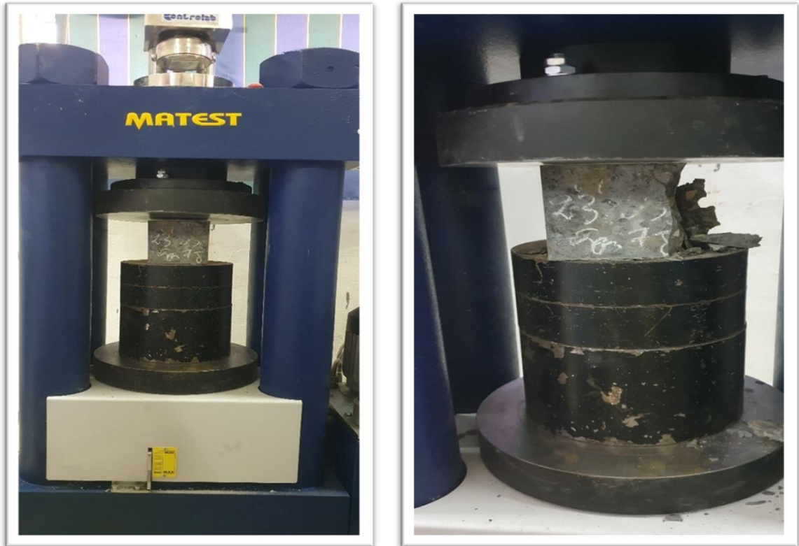
Figure (3.25) : Essais de compression des éprouvettes cubiques (10x10x10) cm 3 des bétons BHP et BHPR
