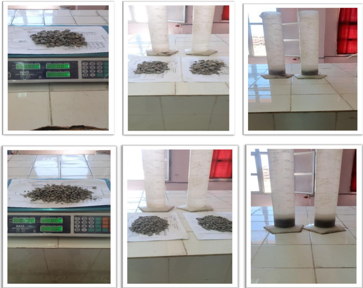
Figure (3.13) : Détermination des masses volumiques absolues de sable, gravier (naturel, recyclé)
