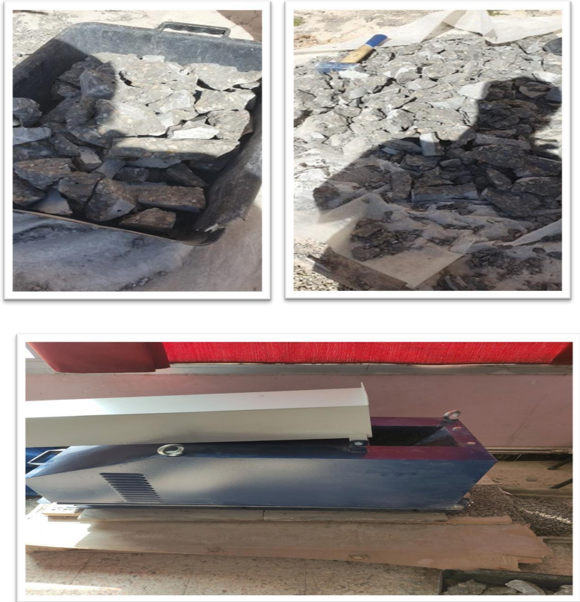
Figure (3.3) : Préparation de granulats recyclés (concassage de béton)
