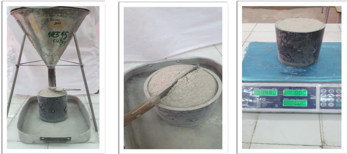
Figure (3.12) : Détermination de la masse volumique apparente de laitier
