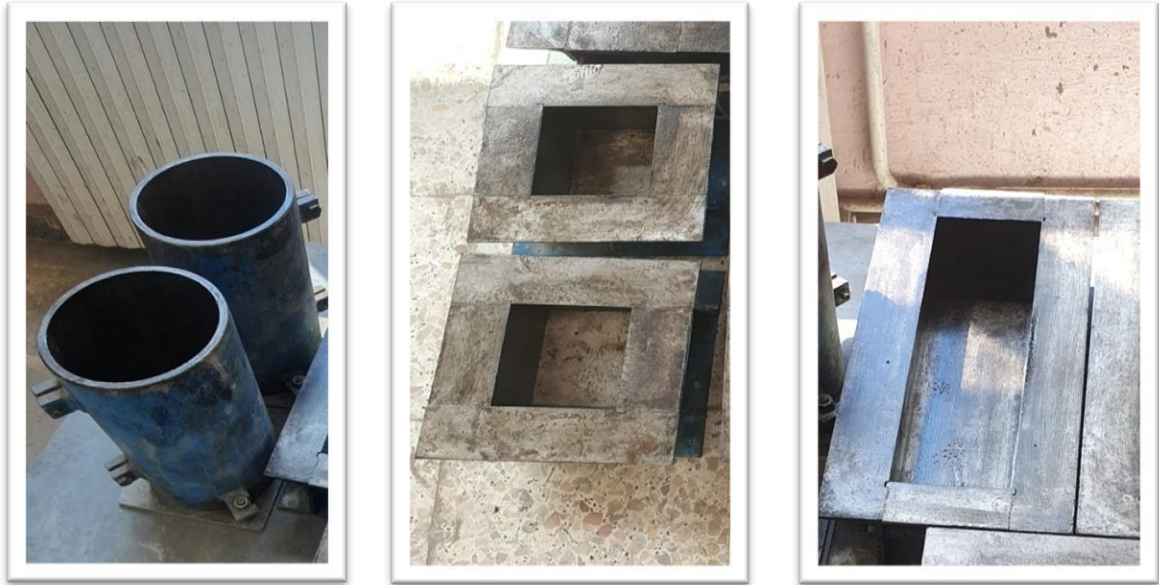
a-Ep cylindriques 16x32cm 2 b- Ep cubiques 10x10x10 cm 3 c-Ep prismatique 10x10x40 cm 3
