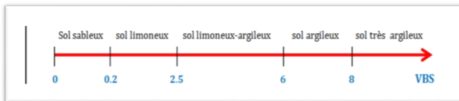
Figure III.12 : Valeurs de bleu de quelques sols. 2,5 < VBS < 6 alors l'échantillon analysé est de type sol limoneux-argileux
