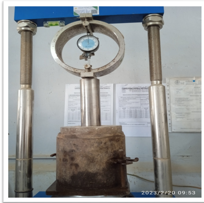
Figure III.21: Essai de Poinçonnement à la Presse CBR.
