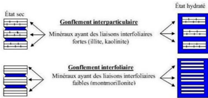
Figure II.7: Schéma présentant les différentes origines du gonflement (Gens et Alonso,1992).
