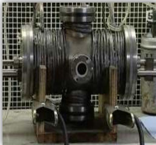
**Figure I- 7:** schéma de la synthèse des CNTs par décharge arc électrique
