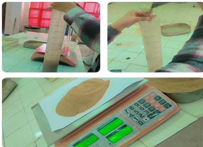
Figure III.1. Matériel pour déterminer la masse volumique
