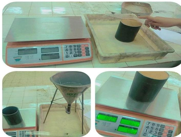
**Figure III.3. La masse volumique apparente (labo de génie civil).**
