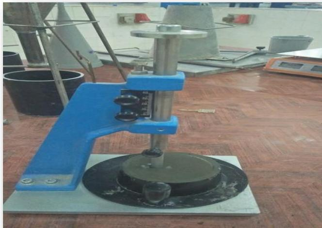
**Figure III.12. Appareil de Vicat**
