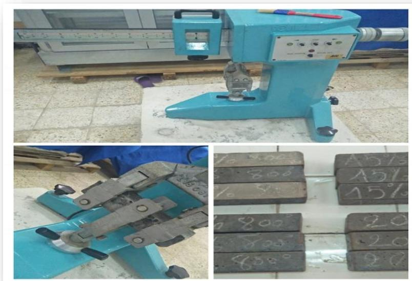
Figure III.26. Machine de flexion
