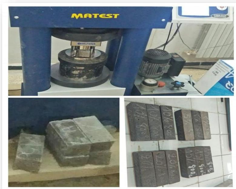
**Figure III.28. Essai de compression.**
