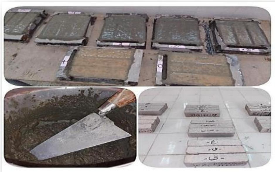
**Figure III.21. Malaxage et préparation des moules.**
