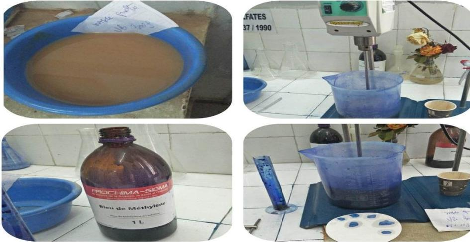
**Figure III.8. Essai au bleu de méthylène**
