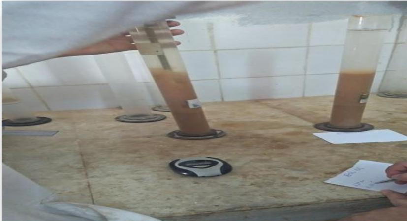
Figure III.7. Equivalent de sable piston (ESP)
