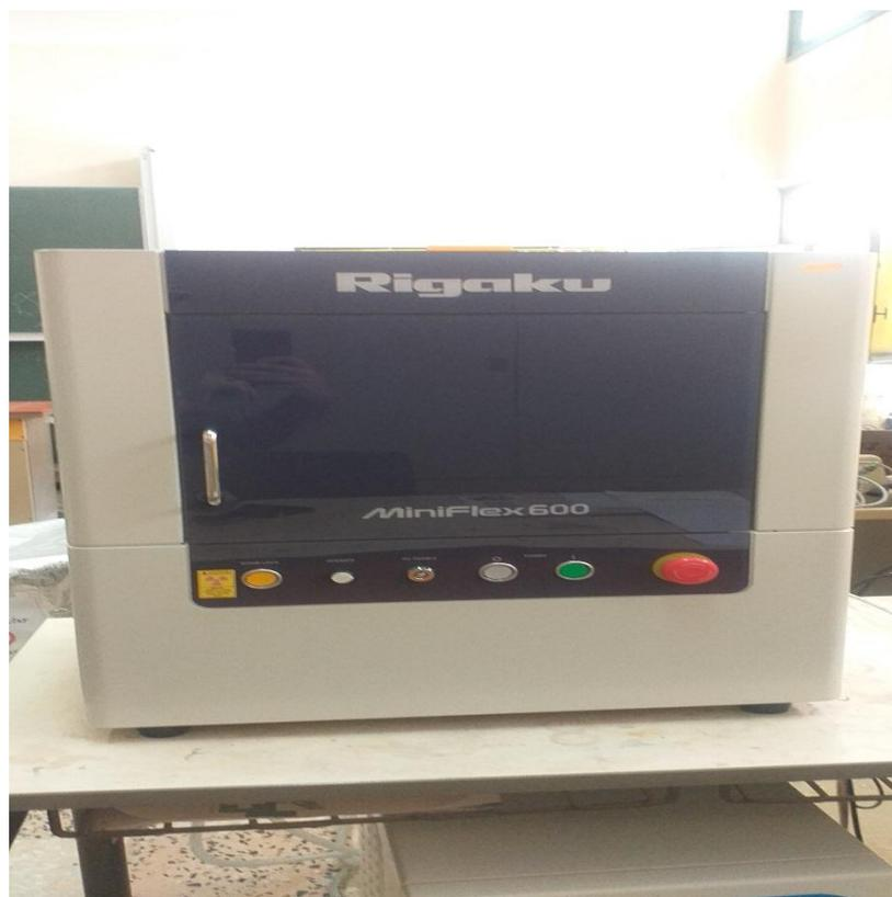
**Figure III.17. Le Diffractomètre (Laboratoire de synthèse et catalyse TIARET)**
