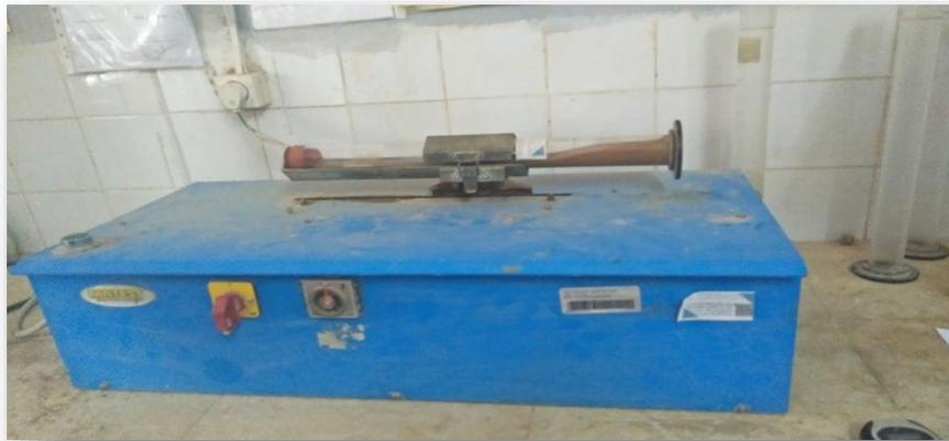
**Figure III.4. Agitateur mécanique à LTPS (Laboratoire Travaux Publics Tiaret)**
