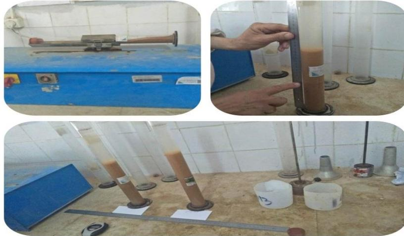
Figure III.5. Repos de 20min pour les éprouvettes
