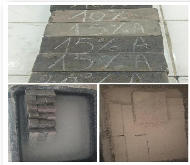
**Figure III.24. Démoulage et conservation des éprouvettes dans l'eau.**
