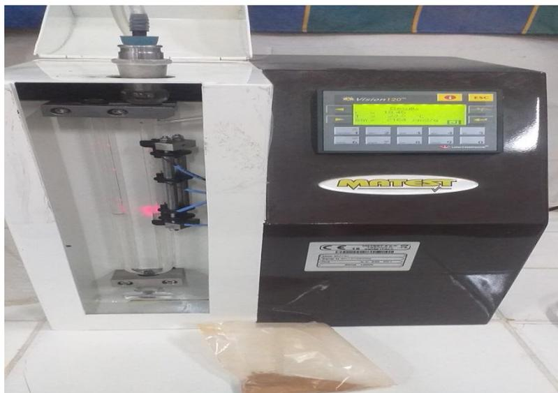
**Figure III.13. Appareil de Blaine (SSB)**
