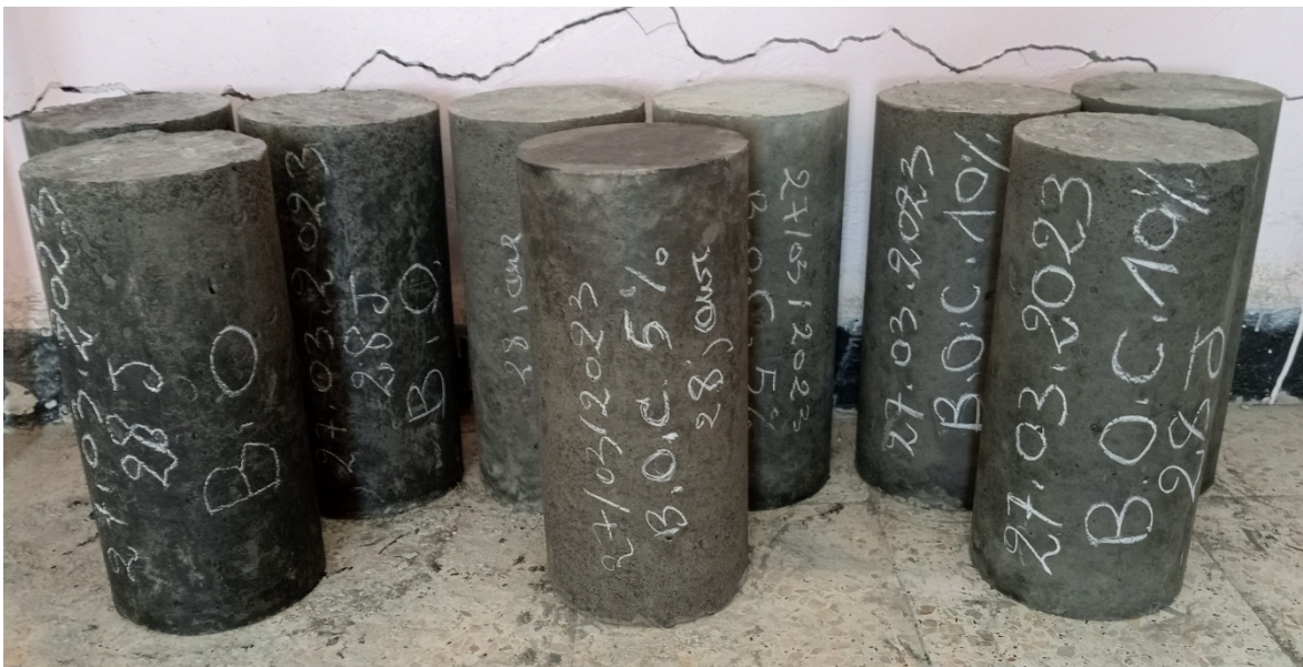
Figure IV.4 : Les éprouvettes après la conservation dans l'eau (28 jour).
