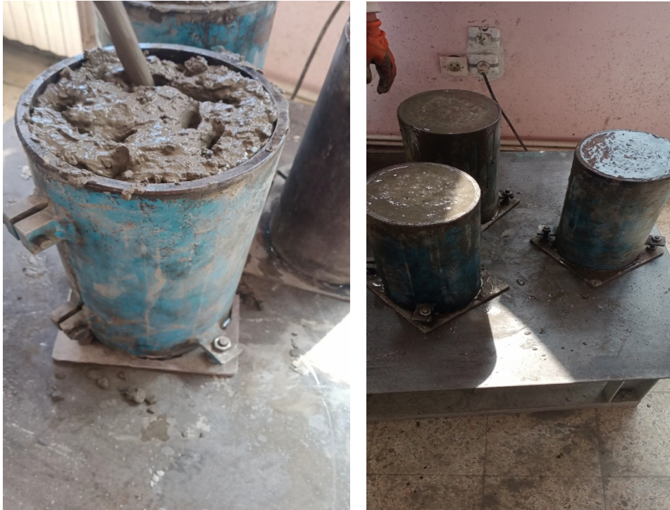
Figure III.30 : Vibration des éprouvettes.
