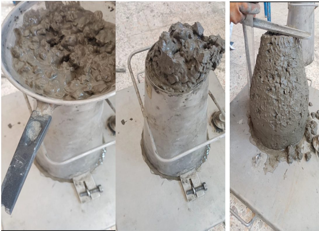
Figure III.29 : l'affaissement de cône d'Abrams d'un béton.
