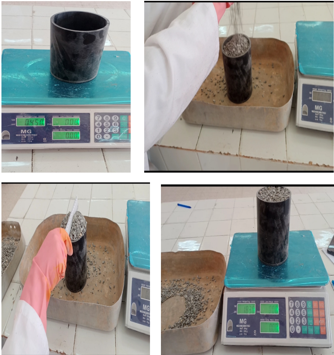
Figure III.17 : Mode opératoire de la masse volumique apparente de gravier 3/8.
