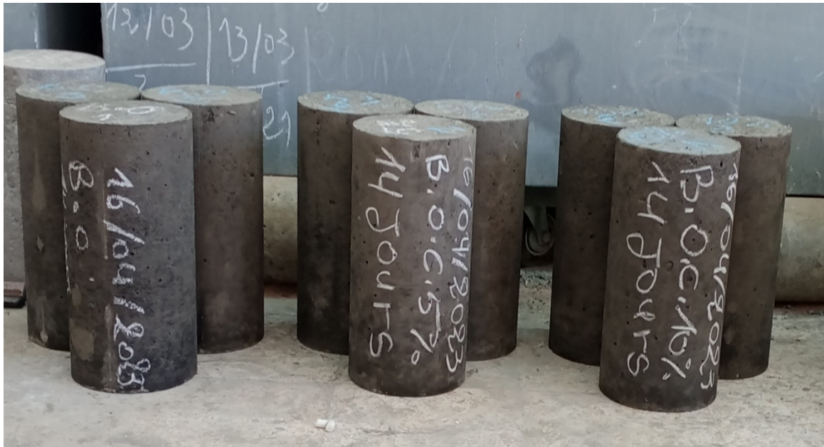
Figure IV.1: Les éprouvettes après la conservation dans l'eau (14 jour).
