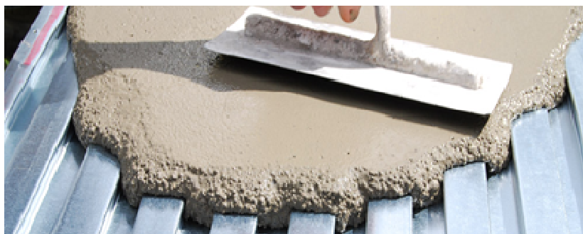
Figure I.18 : Le béton léger.
