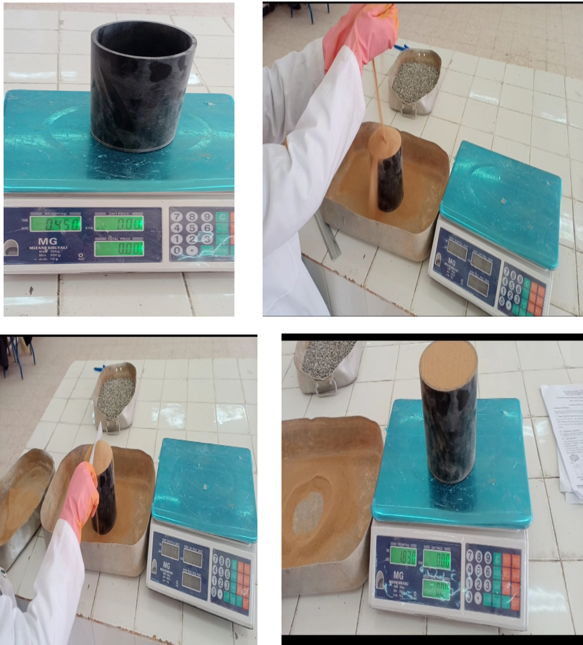
Figure III.16 : Mode opératoire de la masse volumique apparente de sable.
