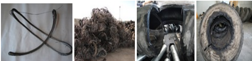
Figure II.10 : Récupération de l'acier (Séparation).
