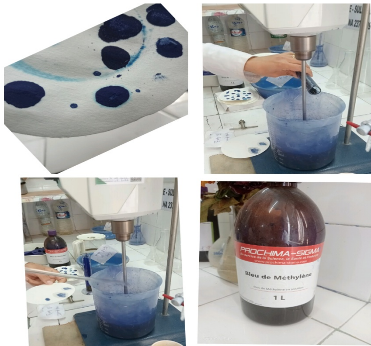
Figure III.14 : Essai au bleu de méthylène.
