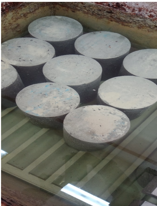
Figure III.32 : Conservation des éprouvettes dans l'eau.
