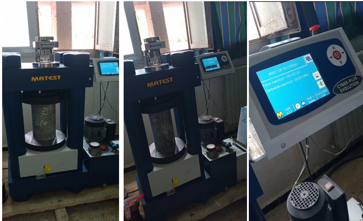
Figure III.33 : La machine pour essai de compression et affichage de la résistance (la machine de laboratoire de MDC).
