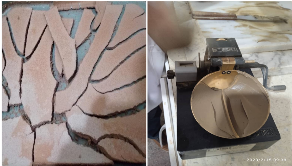
Figure III.5. Appareillage de limites d'Atterberg.
