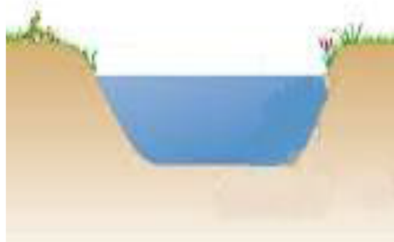
Figures III.4. Toute l'eau accumulée est conservée et devient stagnante, elle pourra être éliminée par l'évapotranspiration, pendant les mois les plus chauds, et par les ouvrages de drainage
