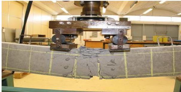
Figure I.7. Résistance à la traction par flexion [6]
