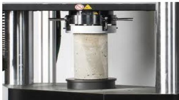
Figure I.5. Essais de compression[5]
