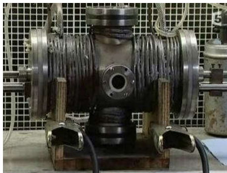
Figure I.19: Schéma d'un réacteur de synthèse de nanotubes monocouche par arc électrique.
