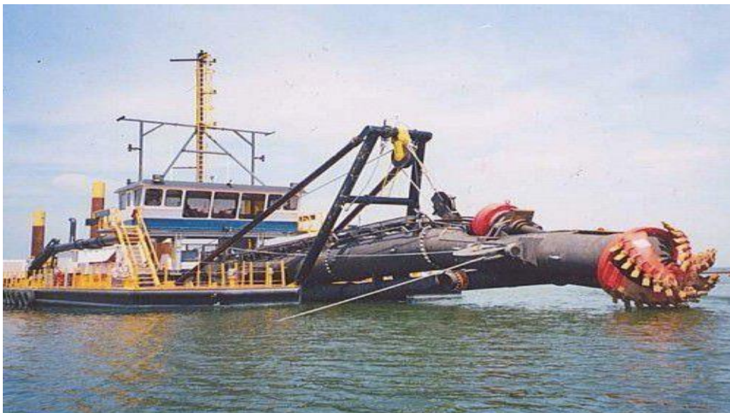
Figure V.9 : Navire spécial drague suceuse a désagrégateur.
