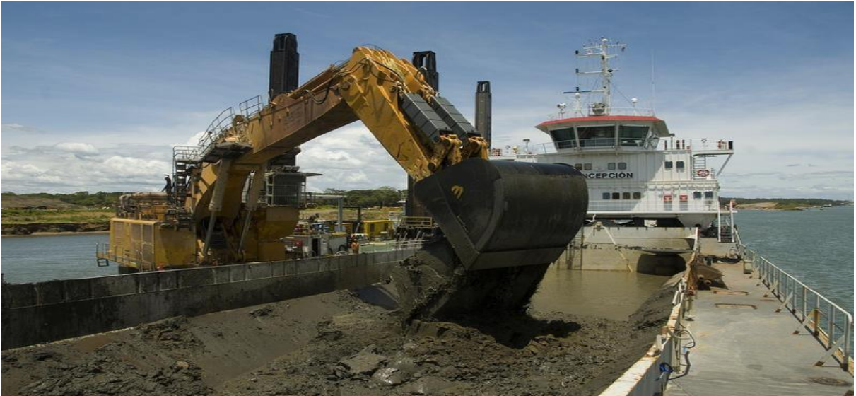
Figure V.10 : La drague à pelle rétro-caveuse à benne preneuse.
