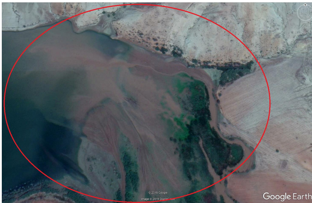
Figure VI.4 : transport solide (entrée du barrage BAKHADDA)
