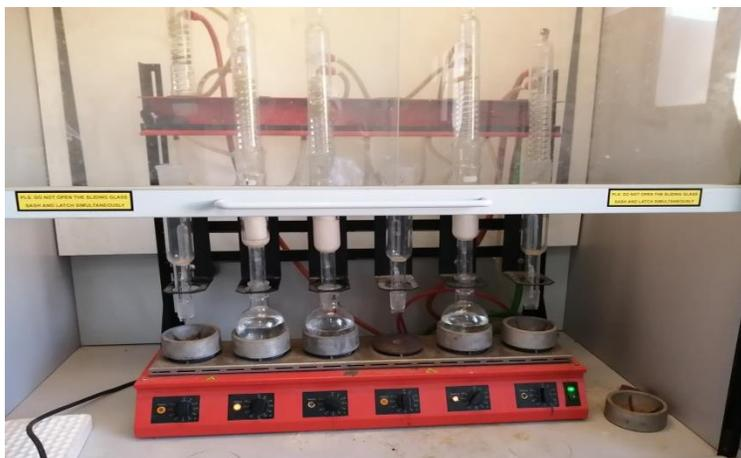
**Figure II.2** : Dispositif expérimental d'extraction par soxhlet (prise par nous-mêmes)
