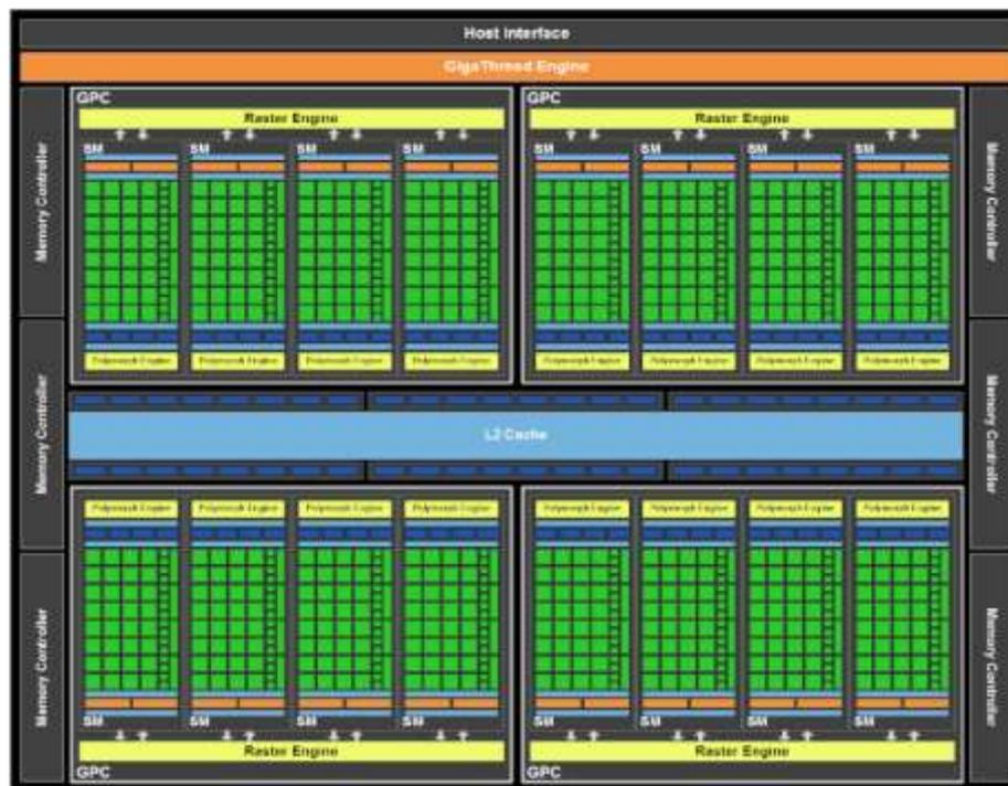
**Figure 1.3.** Architecture du GPU GF100
