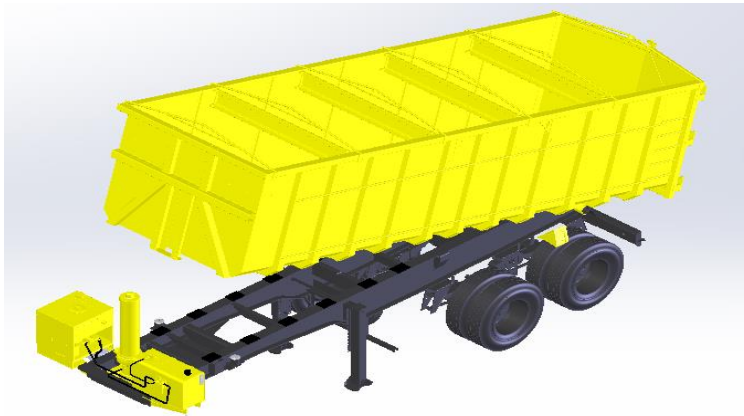
Figure II.7 : réalisation de produit de semi-remorque benne céréalière 31.5 en 3D
