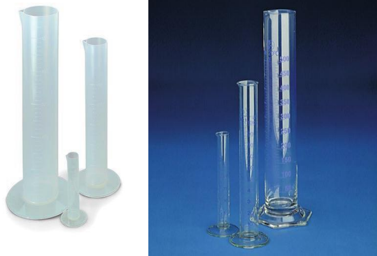
Figure. 2.4 Éprouvette pour déterminer le volume absolu.
