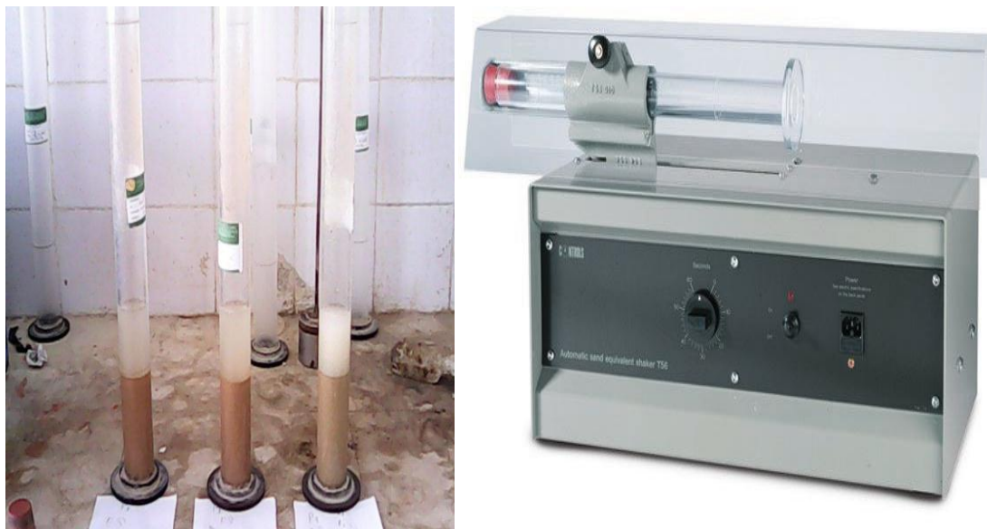
Figure. 2.3 Essais et matériel d'équivalent de sable.
