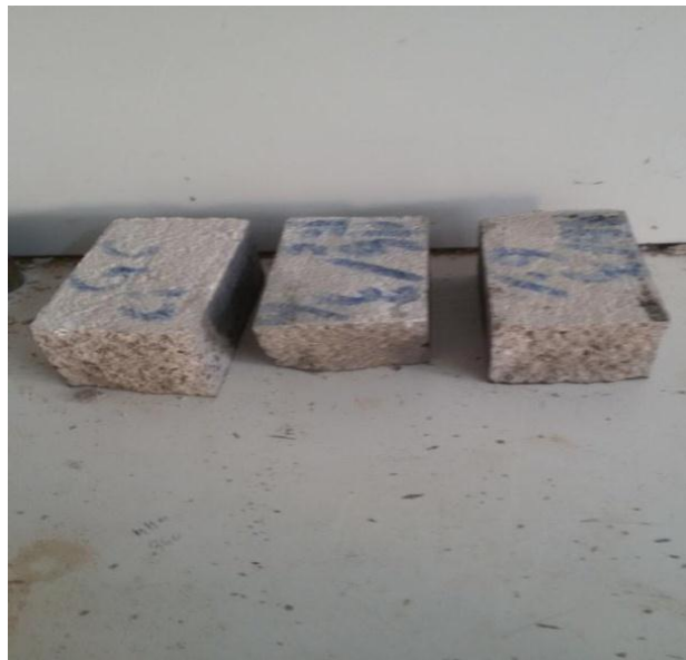
Figure. 2.13 Éprouvette (demi-prismes) pour essai de compression.
