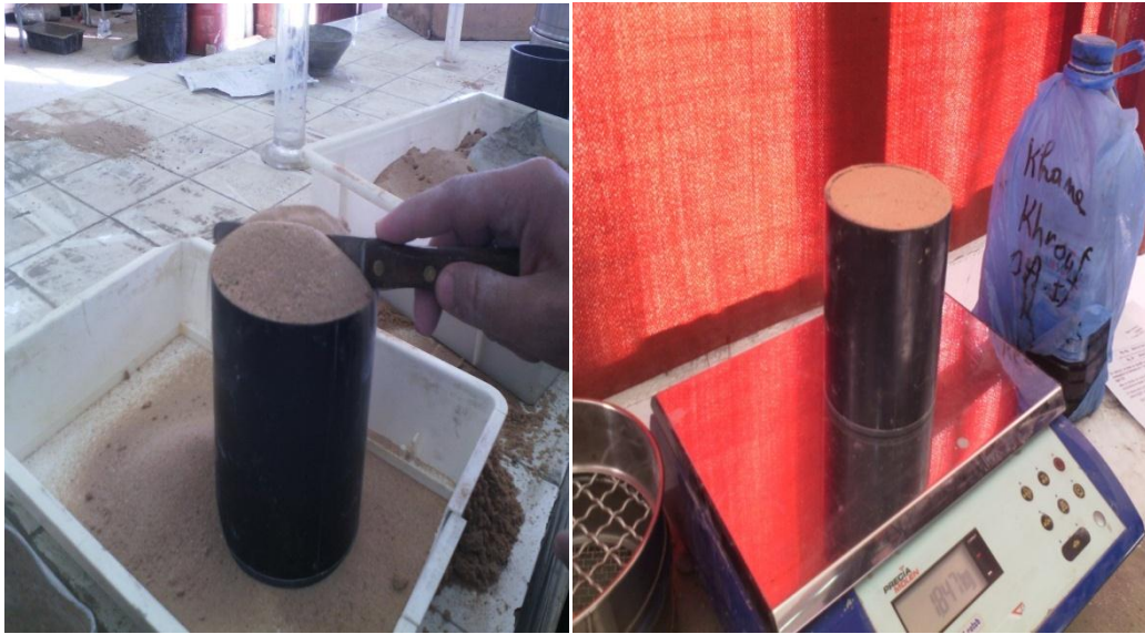
Figure. 2.5. Essai de la masse volumique apparente.
