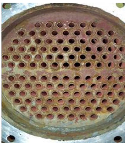
Annexe.3 la corrosion du chaudières industrielle au niveaux de tube du fumée
