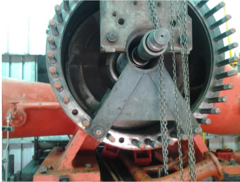
Figure Remontage de l'arbre du compresseur
