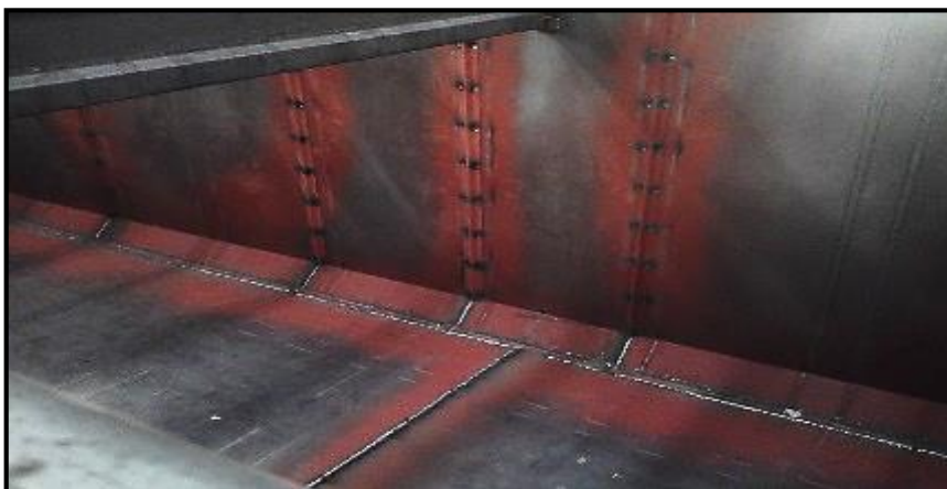
Figure II.7 : soudage intérieur caisse
