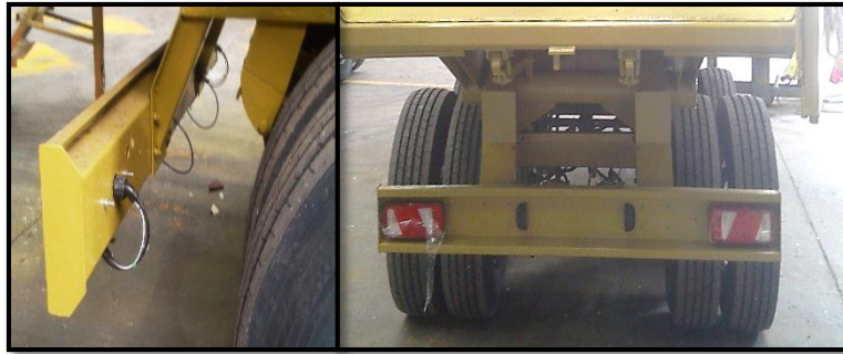
Figure II.18 : fil électrique - les feux
