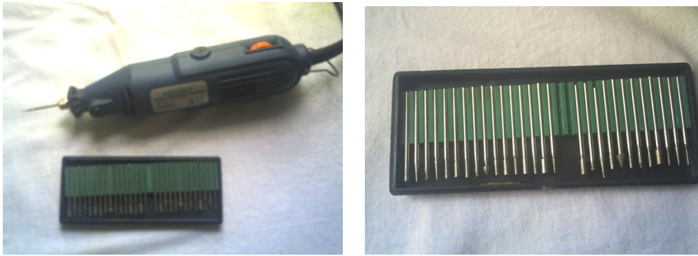
Figure IV 7: matériel utilisé pour la création des défauts
