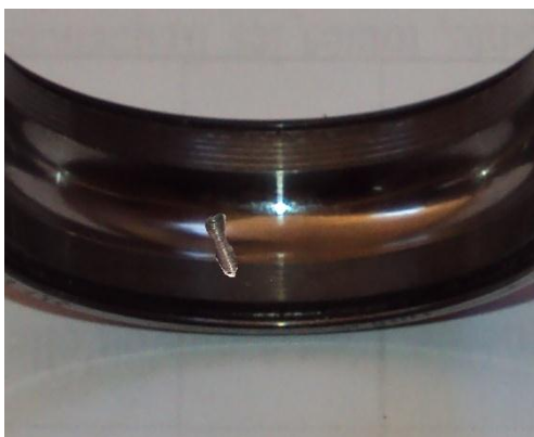
Figure IV.5 : défauts sur la bague extérieure
