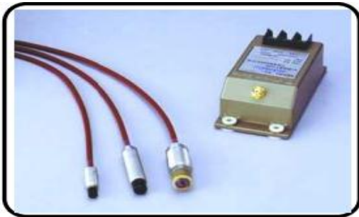
Figure II.5 : proximètres et leur driver [8]
