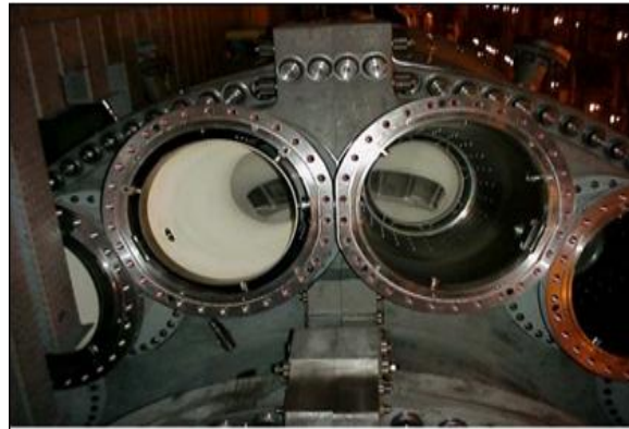
Figure II.10 : Disposition des chambres de combustion, dans une turbine à gaz.
