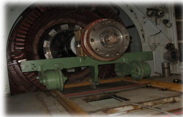
Figure II.19 : Introduction du rotor dans le stator.
