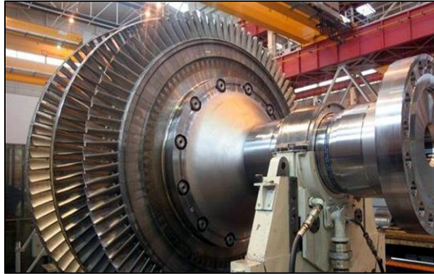
Figure II.16 : Roues de la turbine à gaz.
